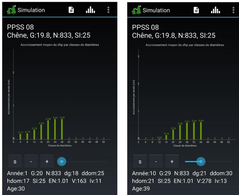
**Fig. 29 : Ecran permettant de visualiser la croissance radiale par classe de diamètre pour les années 1 et 10**
